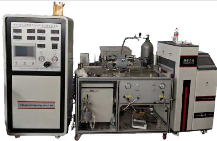
CO2 注入与煤层气强化开发实验模拟系统
