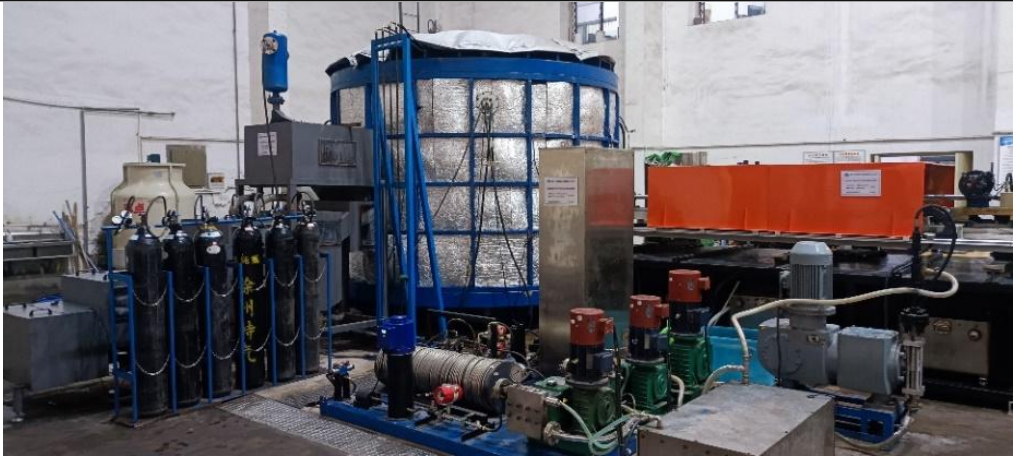
构造煤原位煤层气水平井洞穴卸压开发模拟试验系统
